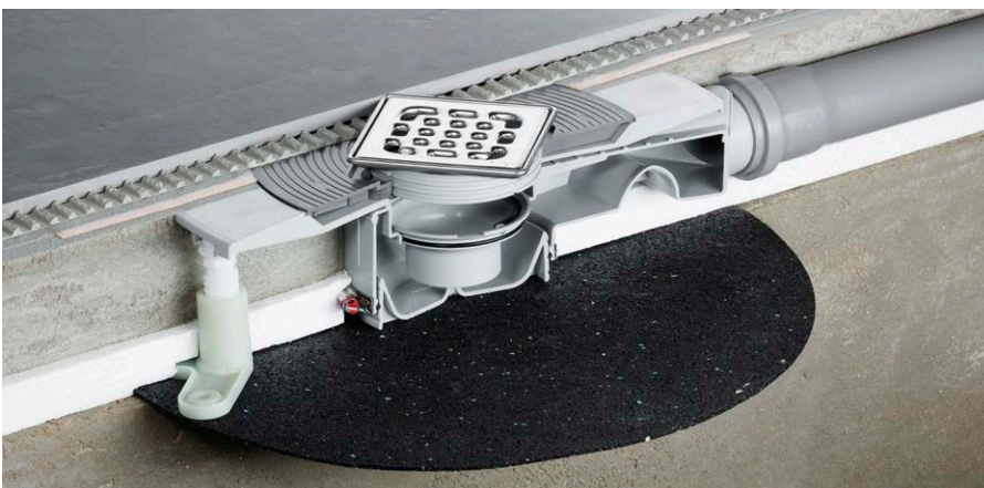
Трап Advantix Top надежно исключает обратный подсос через гидравлический затвор с центральным выпускным отверстием и боковыми накопительными карманами.
