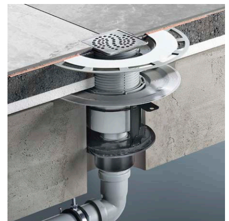
Противопожарный напольный трап R 120, вертикальный монтаж слива для малой монтажной высоты и использования композиционной гидроизоляции.
